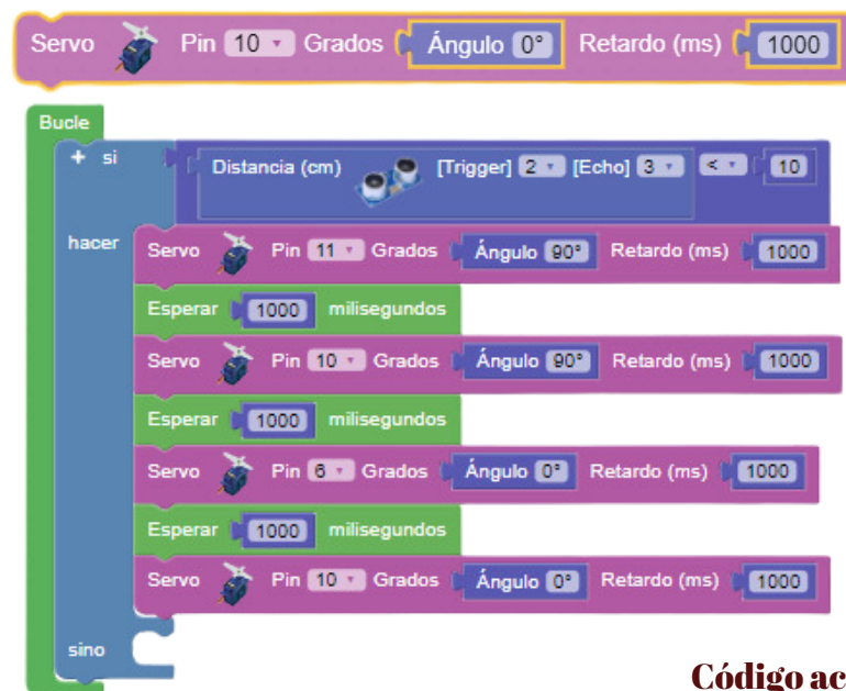
Figura 26. bloque del servomotor, con sus respectivos movimientos.
